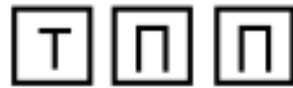
Рисунок 2.1 - Схема промывки после рабочих ванн: Т – технологическая ванна, П – одинарная ванна промывки
