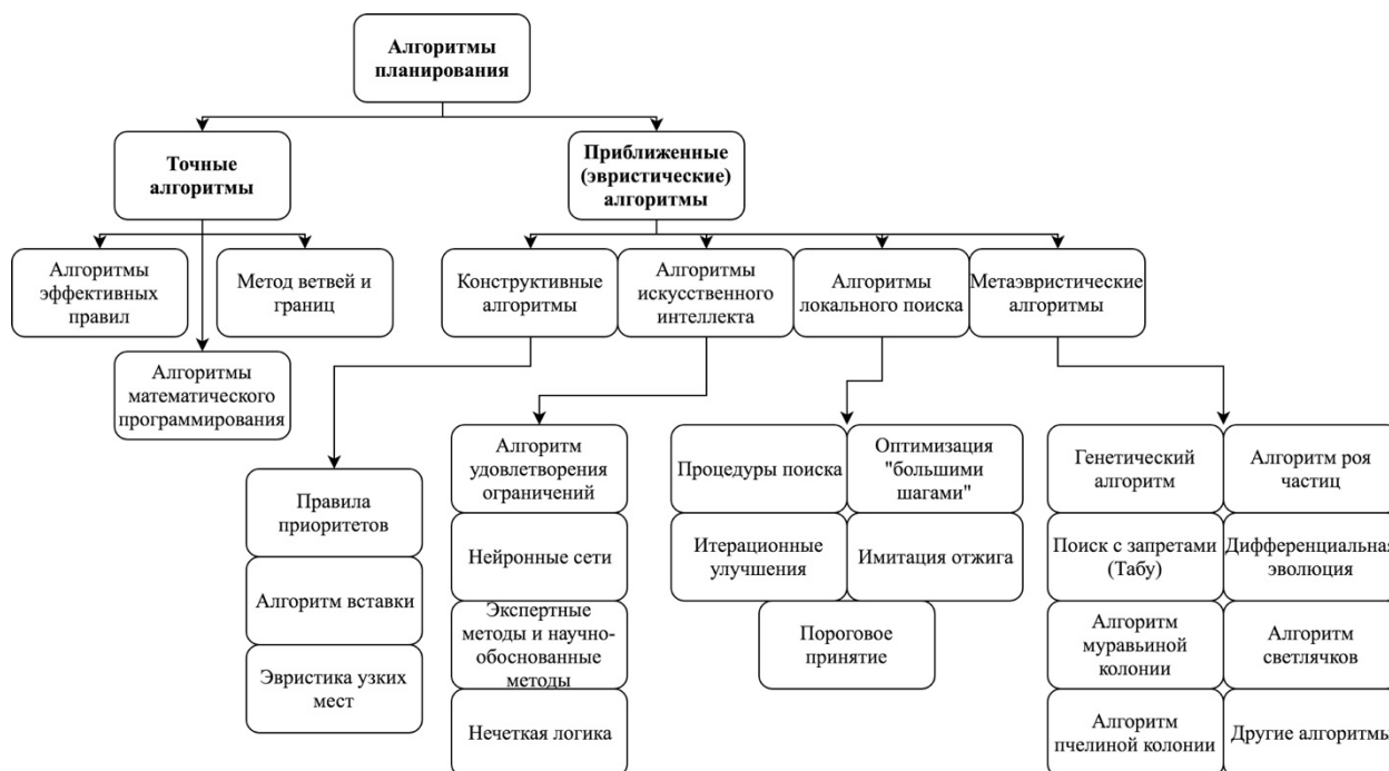
Рис. 2.2. Классификация алгоритмов оперативно-производственного планирования
